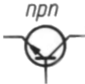
Abb.5 Schaltsymbol eines npn- Transistors
